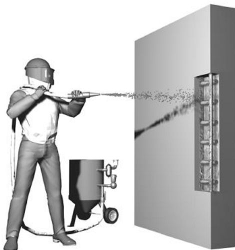
Figura 3 – Remoção da corrosão com jateamento abrasivo
