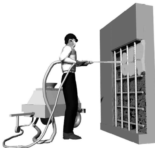
Figura 8 – Aplicação por projeção
